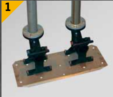
1 不锈钢安装平板方便未来的管路、水泵和基座因为入流增大时升级。下凹的底部可抵抗因较高的地下水位而产生的底部形变。
