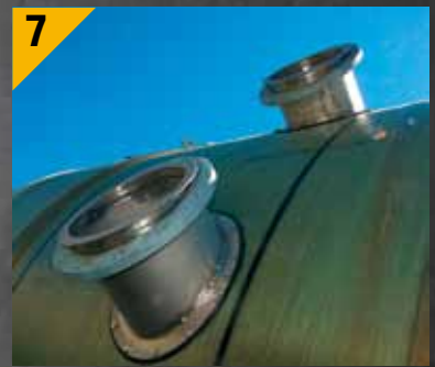
7 管道最大直径DN450，标准材质为AISI 304不锈钢，也可选择AISI 316不锈钢。垂直出水管带坚固的出口铸铁片。
