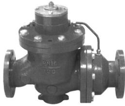
“倒流防止器”也称防污隔断阀，与普通的自来水管“止回阀”不同的是，由于“倒流防止器”采用新工艺，安装了它，当进口水压低于出口水压时，能有效防止水倒流，以保证自来水管网水质的清洁。
