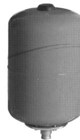
隔膜膨胀罐是一种密封容器，大流量供水时，由水泵加压，罐内贮存的气体被压缩，在小流量或零流量时，被压缩气体泄压膨胀，将贮存在罐内的水输送到供水管网，补充用户的小流量用水或管网渗漏，同时使主泵在小流量和零流量用水时处于停机状态。
